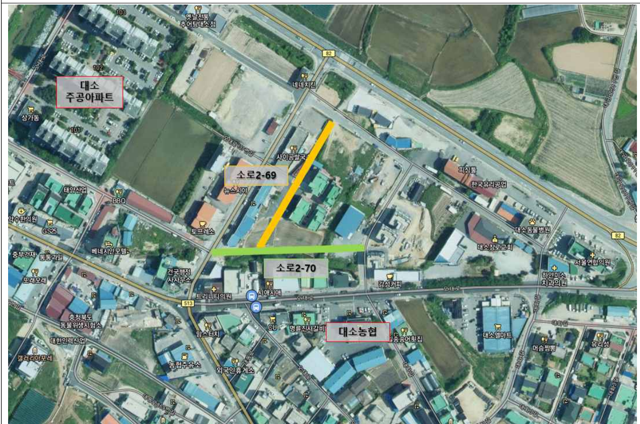
대소면 도시계획도로(소로2-69,2-70) / 다이소 뒤 / L=264m, B=8m 지정액: 300백만원, 1회추경: 450백만원(보상비 추가분)
